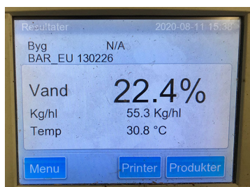
Analyse af vandpct., hektolitervægt og temp. af urensset vare. Foto: Henning Sjørsløv Lyngvig, SEGES.
